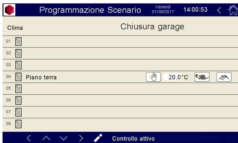
Si può programmare per ciascun regolatore se porlo nello stato di Stop, di Automatico, di Anticongelamento oppure Manuale. In quest'ultimo caso si può anche programmare la temperatura. La programmazione avviene mediante la finestra di dialogo, che compare premendo sul simbolo di stato.
