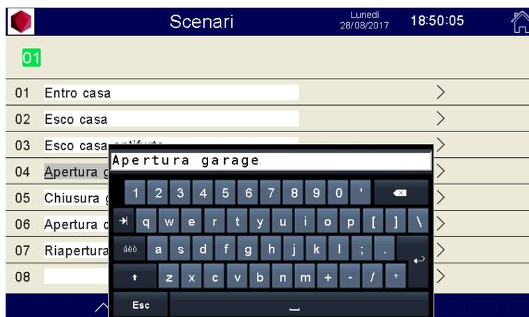
Per programmare i vari elementi di uno scenario bisogna utilizzare le 6 sottopagine, a cui si accede con il pulsante freccia in fondo alla riga.
