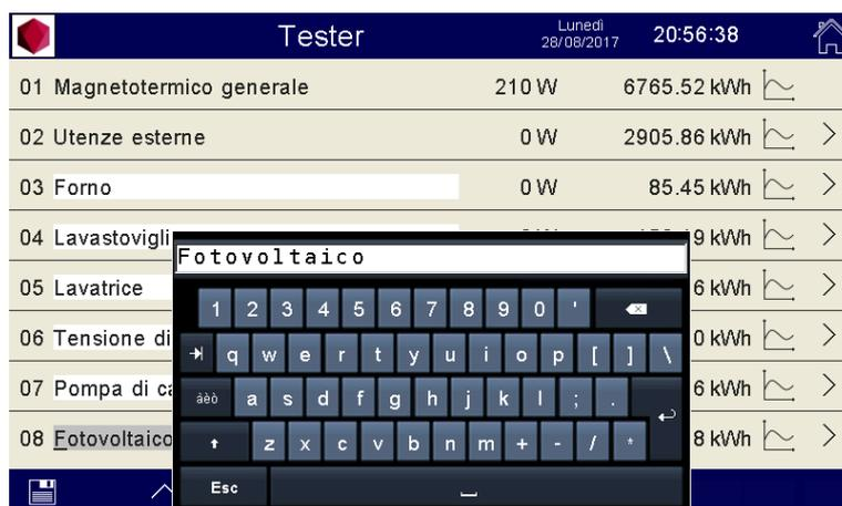
Per ogni tester compare la potenza istantanea assorbita espressa in watt ed il consumo progressivo espresso in chilowattora.
