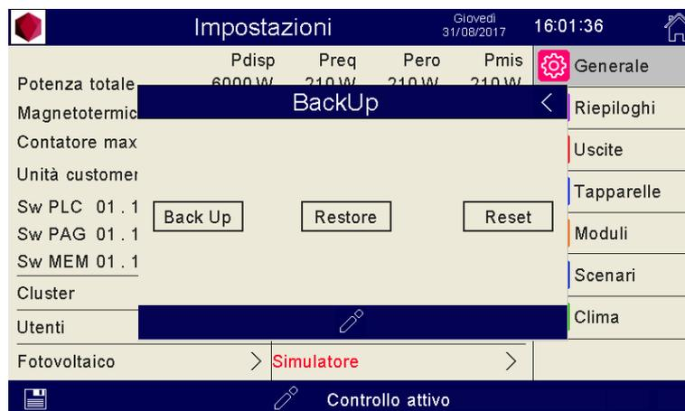
Premendo sul pulsante del dischetto, gli utenti abilitati all'utilizzo della matita di programmazione, possono effettuare le operazioni di Reset, Backup e Restore, mediante la finestra di dialogo dedicata.
